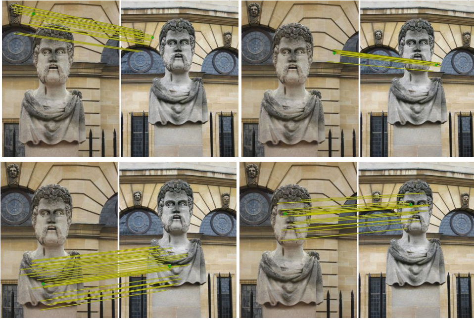
Σχήμα 2.16: Ζευγάρια χαρτών χαρακτηριστικών που ταιρίαξαν και οι αντίστοιχοι inliers μετά από την επιλογή των αναμορφωμένων χαρακτηριστικών, ακολουθώντας το παράδειγμα των Σχημάτων 2.13 και 2.14. Οι inliers είναι λιγότεροι από εκείνους του Σχήματος 2.14, αλλά αρκετοί για να ταιριάξουν τις δύο εικόνες, ειδικά εφόσον οι inliers αθροίζονται πάνω σε όλους τους χάρτες χαρακτηριστικών. Σημειώνουμε πως αυτοί δεν είναι οι μοναδικοί χάρτες για τους οποίους εμφανίστηκαν inliers ανάμεσα στις απεικονιζόμενες εικόνες.
