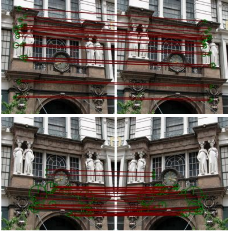
Σχήμα 4.3: Πάνω: δείγμα από ομάδα inliers οι οποίοι εντοπίστηκαν με τον αλγόριθμο SSM στην αρχική εικόνα, και αντιστοιχούν σε επαναλαμβανόμενη δομή. Κάτω: δείγμα από ομάδα inliers οι οποίοι εντοπίστηκαν με τον αλγόριθμο SSM ανάμεσα στην αρχική εικόνα και την αντικατοπτρισμένη.
