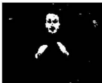
σχήμα 2 κατωφλίωση της προηγούμενης εικόνας με \rho > 0.8
