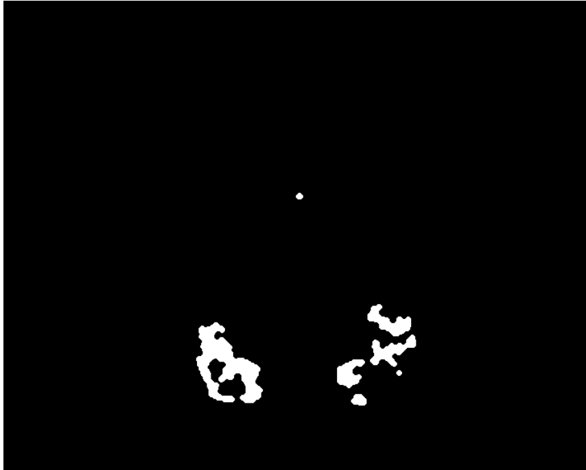
Εικόνα 14: Εικόνα του κατωφλιωμένου πίνακα μετά από μορφολογικό κλείσιμο και μετά μορφολογικό άνοιγμα
